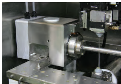
Питатель для подачи проволоки с больших катушек
